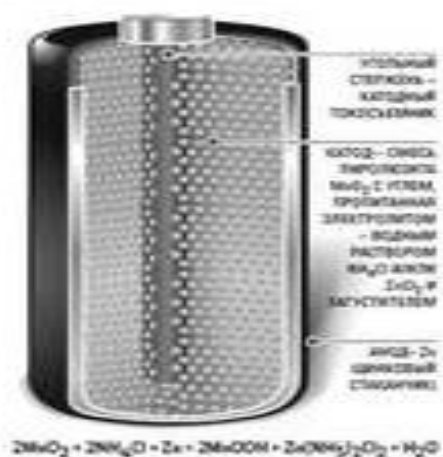
Малюнок 2 . Конструкція побутової алкалінової батарейки
